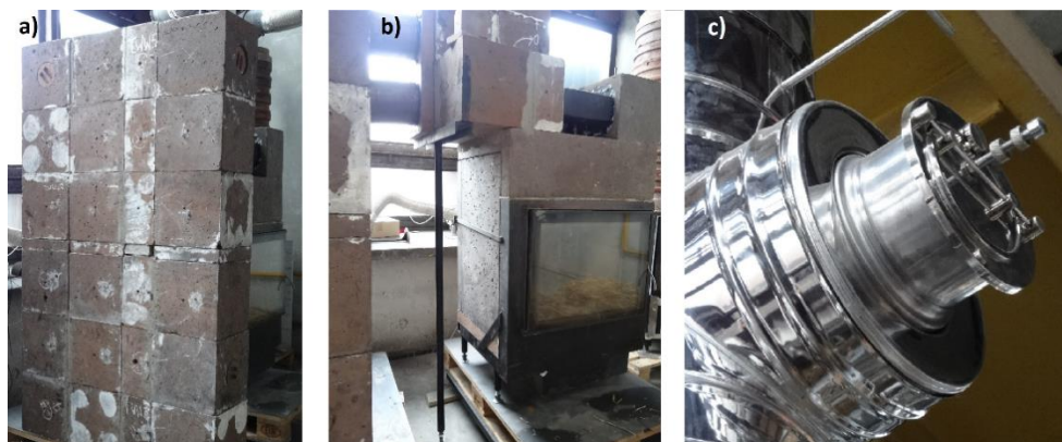
Rys. 3. Elementy stanowiska doświadczalnego: a) akumulacyjny wymiennik ciepła, b) korpus paleniska, c) miarkownik ciągu zainstalowany na przewodzie dymowym
