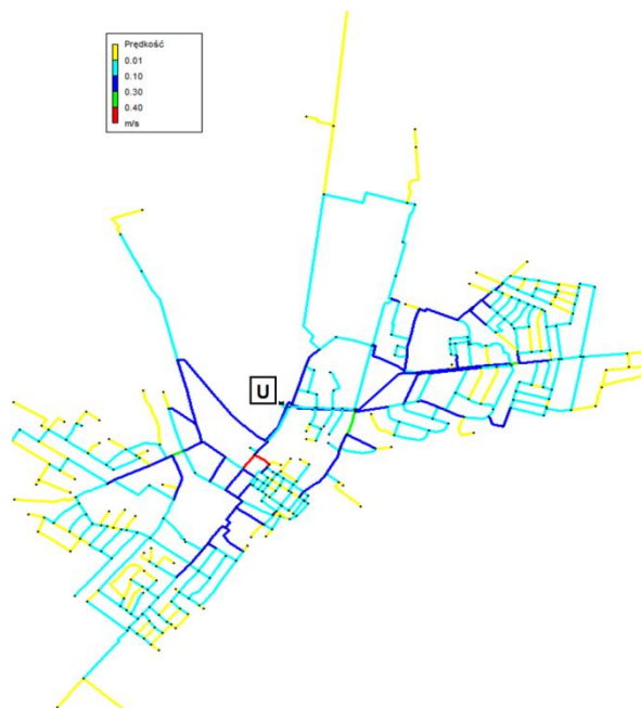
Rys. 10. Rozkład prędkości dla rozbioru maksymalnego (19.05.2015 r. – wtorek godz. 20:00); U-ujęcie
